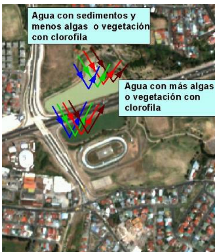
Figura 13: Efecto del contenido de algas en la reflectancia de cuerpos de agua. Imagen IKONOS.
