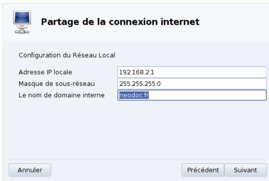
Figure 4-9. Configuration du réseau local
